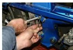
Positionner les 2 vis BTR 6x35 avec les écrous, rondelles et contre écrou fourni pour faire support à la bobine haute tension du PREMIUM
