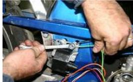
Présenter la bobine haute tension et serrer la sur son support avec le câble de masse ainsi qu'avec le câble vert/jaune du stator et noir du diagramme.
