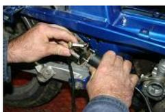
Déposer la bobine haute tension d'origine.
