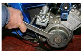
Tourner le rotor dans le sens inverse jusqu'à son blocage et desserrer l'écrou avec une clé de 32.
