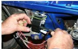
Brancher le câble haute tension d'origine avec la protection
