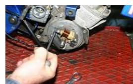
Déposer les vis de fixation du stator.
