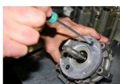
Positionner la platine sur le carter moteur avec la sortie de câble en haut à gauche et serrer la avec les 2 vis tête fraisées 6x20 fournies.
