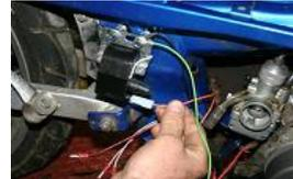
Connecter le câble orange du diagramme sur la bobine.
