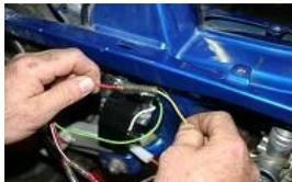
Connecter le câble jaune du stator avec le jaune du faisceau.
