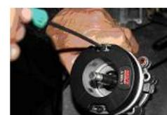
Fixer le stator à l'aide des 2 vis Allen 5x30 fournies et de leurs rondelles.
