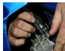
Retirer la bougie avec une clé de 21. Placer un bloc piston à la place de la bougie.
